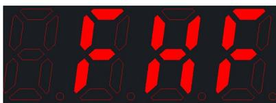
防火阀故障(信号被配置时需短接)
