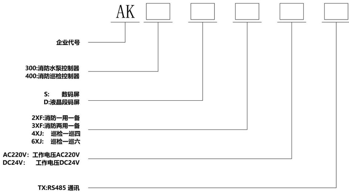
订货完整型号：AK400-D4XJ AC220V(四巡检)，AK400-D6XJ AC220V(六巡检)
