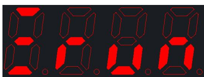
3#水泵运行(不使用互感器)
