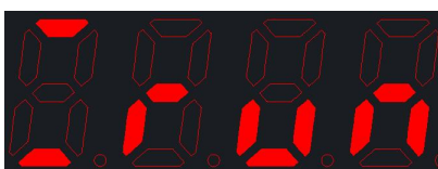
2#水泵运行(不使用互感器)
