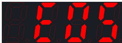
故障代号显示(外部电源故障)
