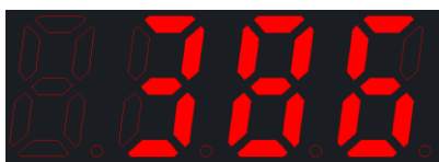
工作时显示 Uab 电压值（单位：V）
