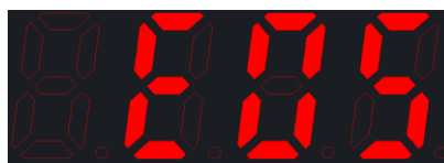
故障代号显示(外部电源故障)
