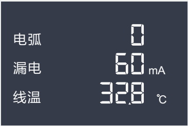
电弧0次 漏电60mA 线温32.8℃
