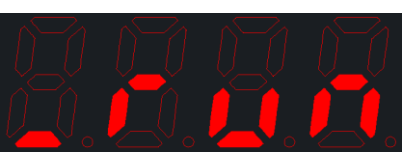
1#水泵运行(不使用互感器)
