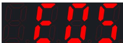
故障代号显示 (外部电源故障)
