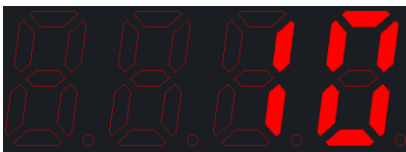
信号延时启动倒计时(10 秒) (P102 设置大于 5 秒时显示)
