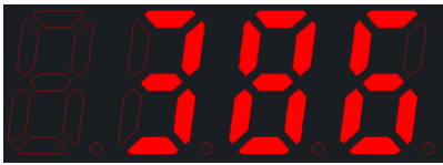
工作时显示 LN 接口输入电压按比例转化的电压值(单位: V)
